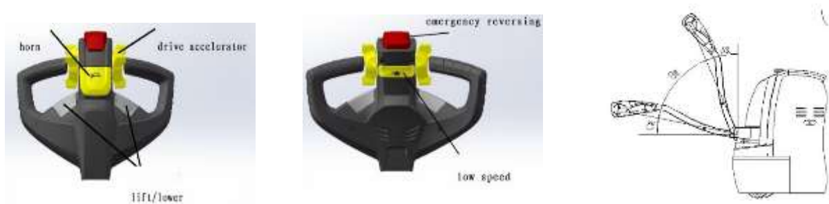
Рис.6 - Работа аварийного заднего хода штабелера
